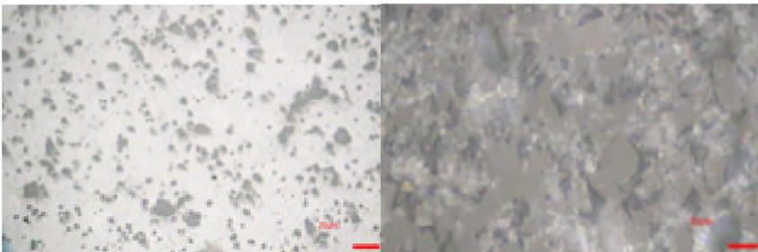
**Bild 35:** Oberfläche  $Al_2O_3$  poliert (links) und nach korrosiven Angriff (rechts)
