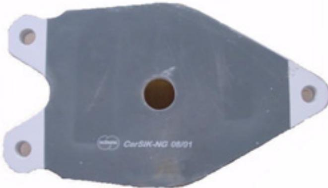
**Bild 8:** Brennplatte aus NSIC
