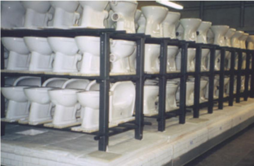
**Bild 9:** BHM aus SISIC zum Brennen von Sanitärkeramik
