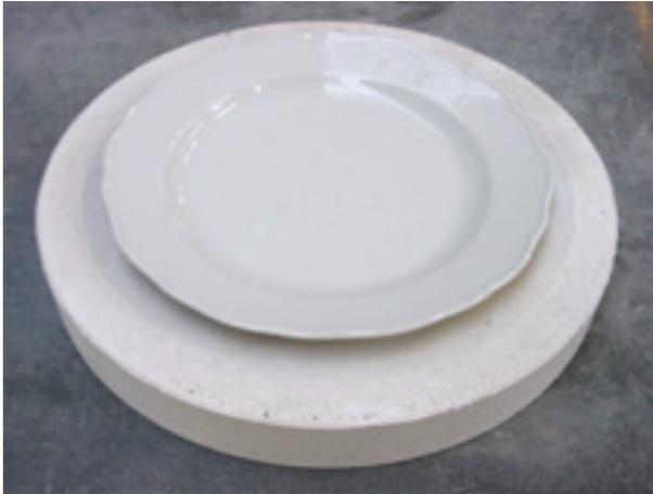
**Bild 3:** Brennhilfsmittel aus tongebundenem SiC für Teller
