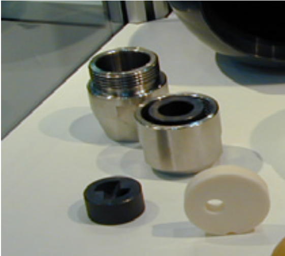
Bild 10: Keramische Düse im Metallmantel
