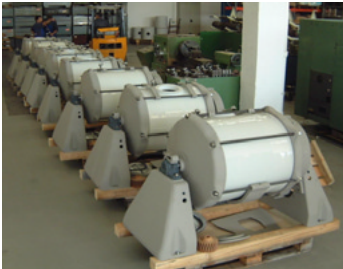
Bild 3: Trommelmühlen mit massiver Keramiktrommel
