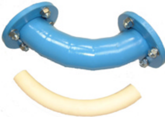
Bild 7: Keramikrohrbogen mit PUR im Stahlmantel eingegossen
