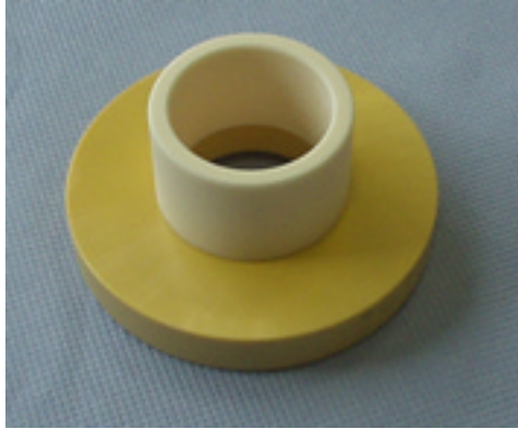
Bild 2: Al 2 O 3 –Rohr verklebt mit ZrO 2 -Sitzring
