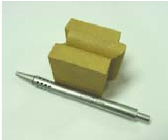
**Bild 3:** Wärmeisolerstein aus CaO-stabilisiertem Zirkoniumoxid
