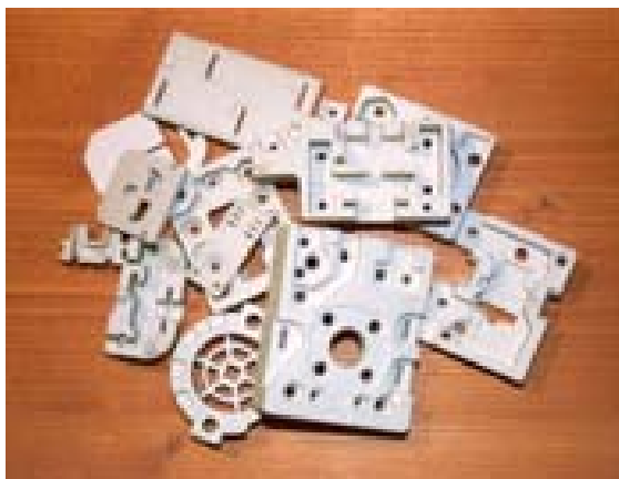
Bild 6: Verschiedene Trockenpressteile aus Steatit
