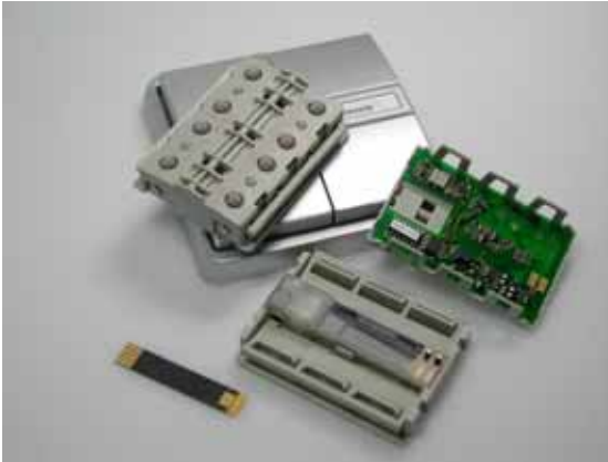
Bild 12: Darstellung eines Funkschalters mit Piezogenerator zur Gewinnung der benötigten Energie aus der Tastenbetätigung
