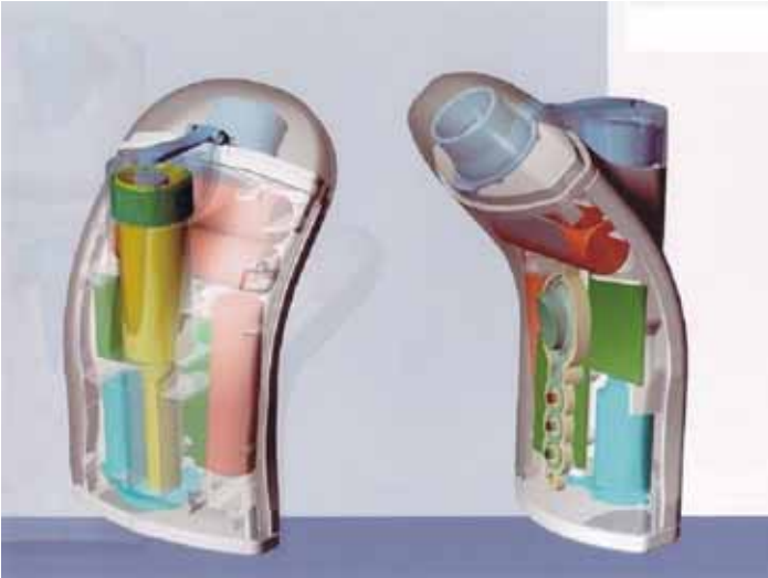
Bild 14: Schematischer Aufbau eines piezokeramischen Ultraschall Tascheninhalators für die Medizintechnik. Mit dem Tascheninhalator können sowohl Medikamente gegen Asthma und chronische Lungenerkrankungen als auch Medikamente zur Schmerztherapie zerstäubt werden
