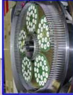
Doppelseitenquerschleifen mit Planetenkinematik von Dichtscheiben aus Aluminiumoxid
