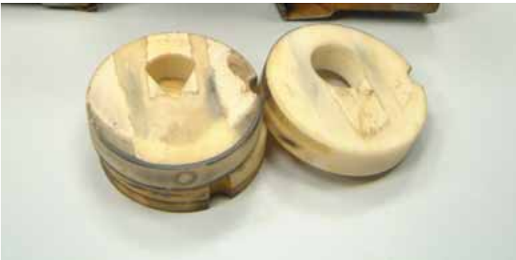
Bild 7: Korrodierte Teile nach Einsatz im HF-haltigen Medium
