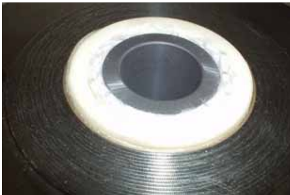
Bild 21: mehrlagige Keramik in Schlackeabsticharmatur
