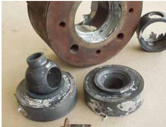
Bild 5: Bauteile aus SSN in einem Kugelhahn für flüssiges Zink
