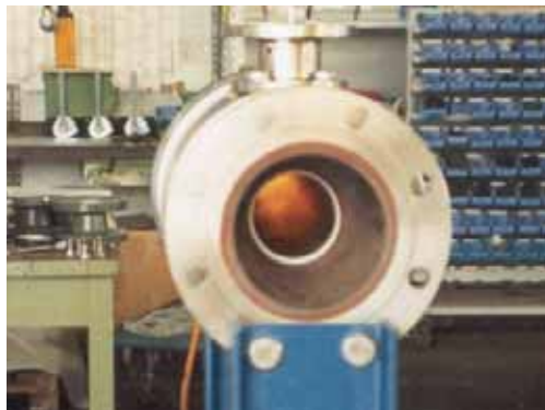
Bild 9: HT-Armatur mit ZrO_2 -Keramikinnenleben
