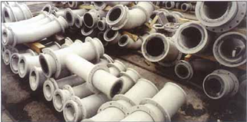
Bild 8: Komponenten für Rohrleitungssysteme vor der Montage
