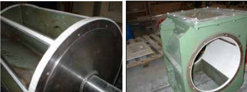
Bild 13: Mantel und Rotor mit Verschleißschutz aus Aluminiumoxid
