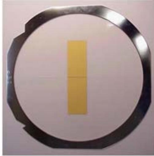
Die Mikroaktoren können per Pick and Place von den Wafer Frames abgenommen und weiterverarbeitet werden.
