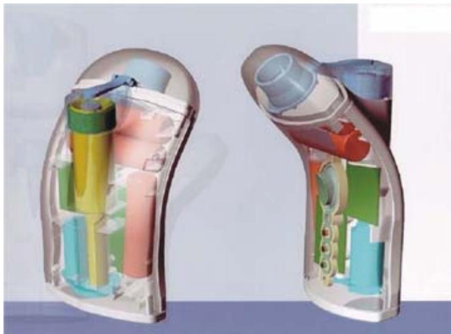
**Bild 13:** Schematischer Aufbau eines piezokeramischen Ultraschall Tascheninhalators für die Medizintechnik. Mit dem Tascheninhalator können sowohl Medikamente gegen Asthma und chronische Lungenerkrankungen als auch Medikamente zur Schmerztherapie zerstäubt werden.
