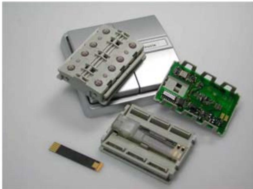
**Bild 11:** Darstellung eines Funkschalters mit Piezogenerator zur Gewinnung der benötigten Energie aus der Tastenbetätigung.
