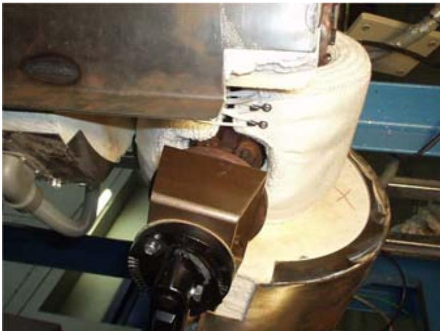
**Bild 25:** Kugelhahn für flüssiges Zink
