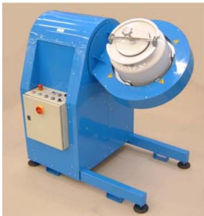
**Bild 7:** Labormühle mit massivem Keramiktopf
