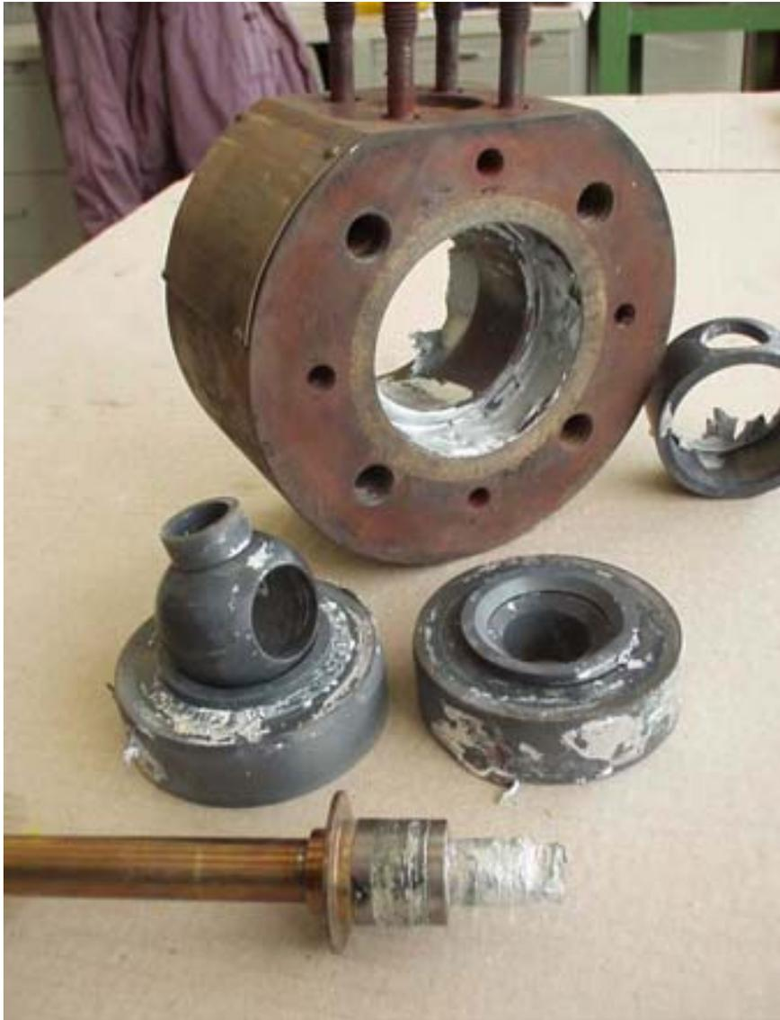
**Bild 26:** Kugelhahn für flüssiges Zink
