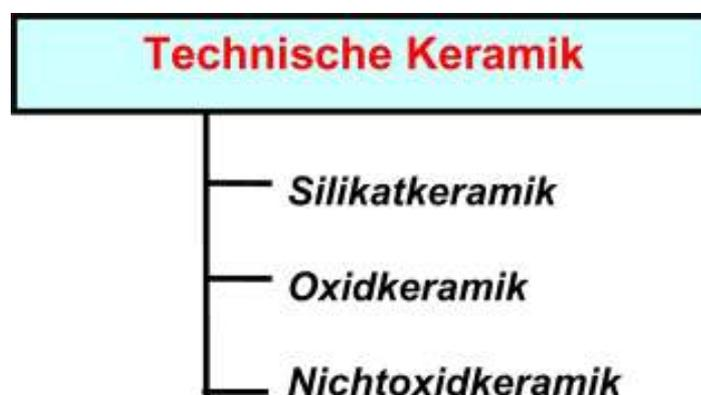
**Bild 3:** Werkstoffgruppen der Technischen Keramik
