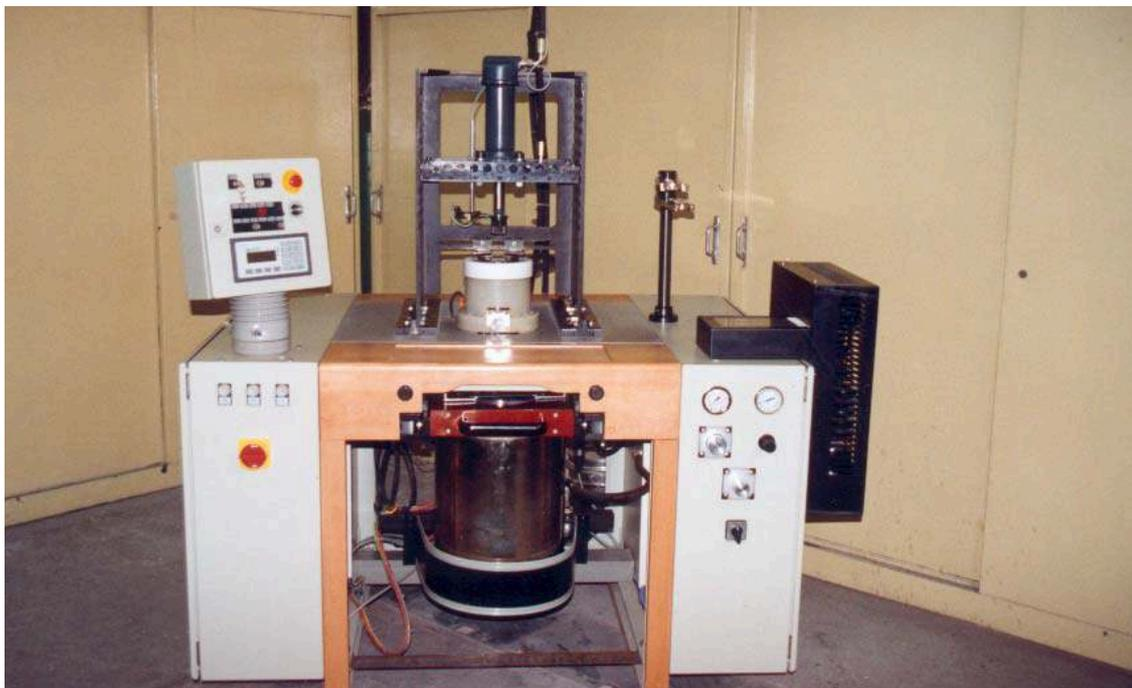
**Bild 4:** Heißgießmaschine
