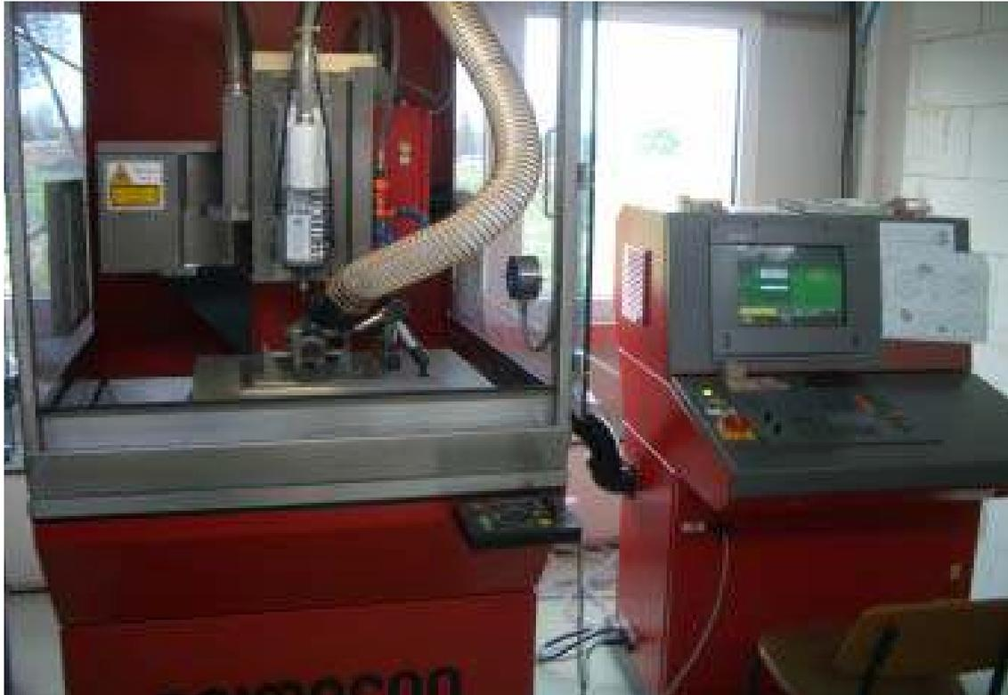
**Bild 1:** 5-Achs-Mikrofräsmaschine
