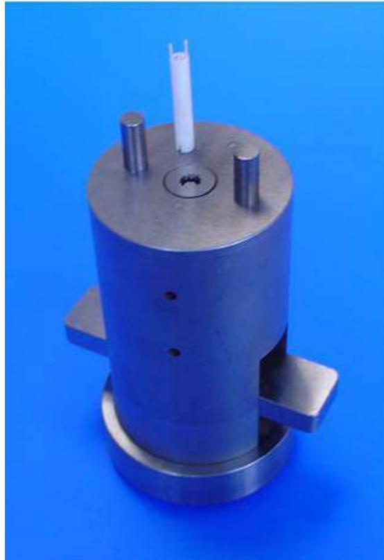
**Bild 10:** Heißgießwerkzeug Außentiegel
