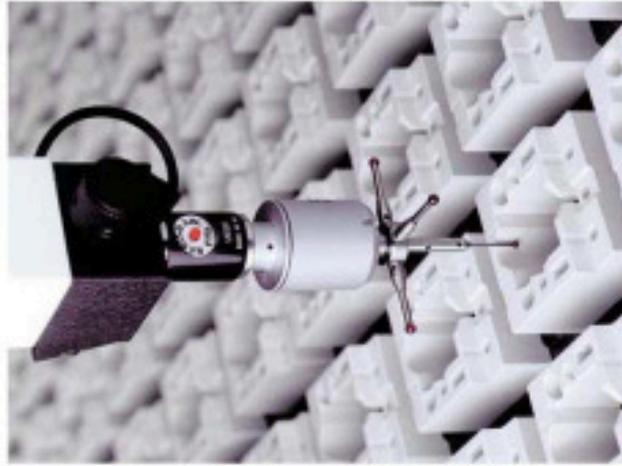
Keramische Niederspannungsbauteile (Qualitätssicherung)
