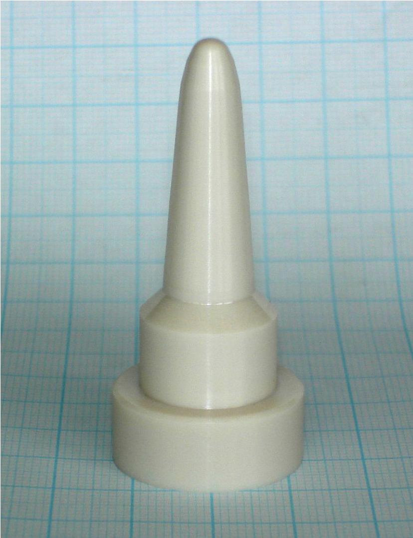
**Bild 3:** Ventilkegel aus ZrO<sub>2</sub> Mg-PSZ
