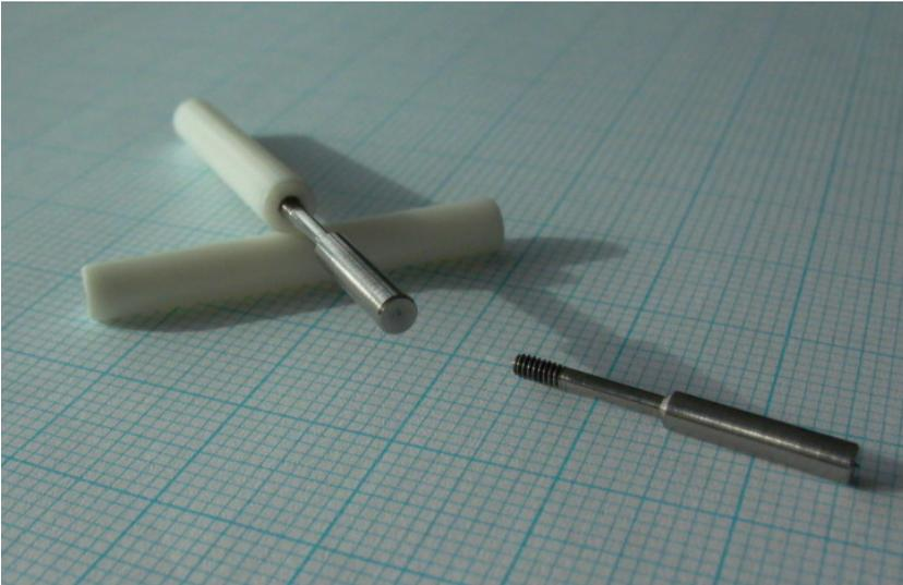
**Bild 1:** Gewindehülse in  $ZrO_2$  mit Innengewinde M 1,6
