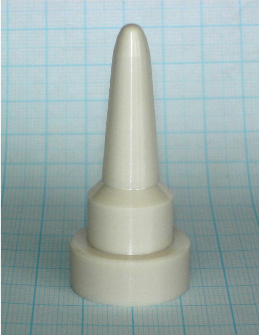
**Bild 3:** Ventilkegel aus  $ZrO_2$  Mg-PSZ
