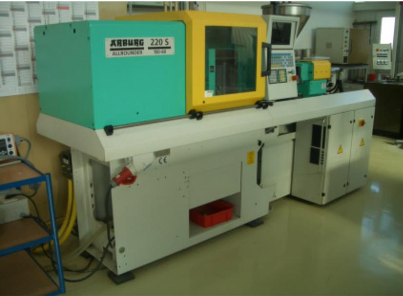
**Bild 2:** Spritzgussmaschine der Fa. Arburg
