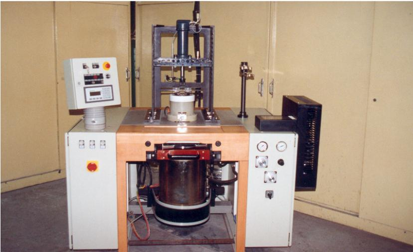
**Bild 4:** Heißgießmaschine
