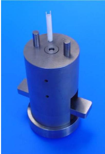
**Bild 10:** Heißgießwerkzeug Außentiegel
