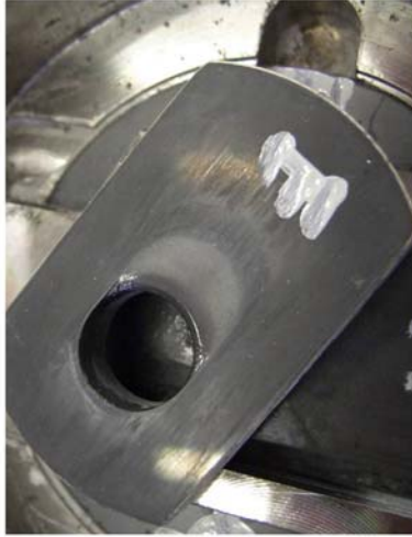
Bild 28: Dichtscheibe mit Kavitationsschäden
