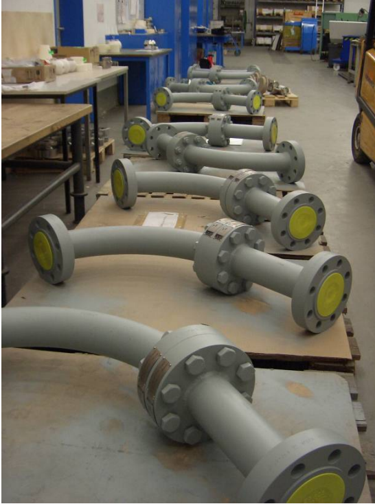
Bild 21: Rohre für Hochdruckkohleförderleitung
