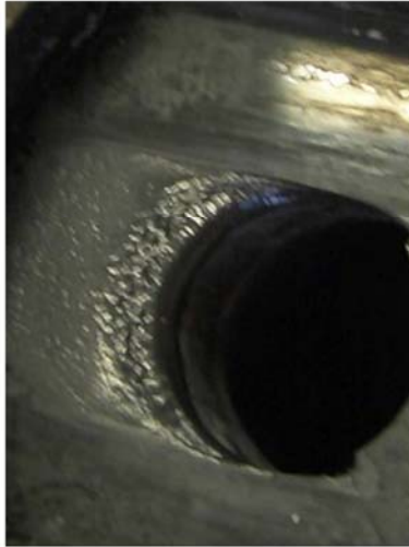
Bild 27: Hubscheibe mit Kavitationsschäden
