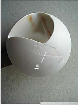
Bild 9: Kugel ZrO2 ausgestrahlt
