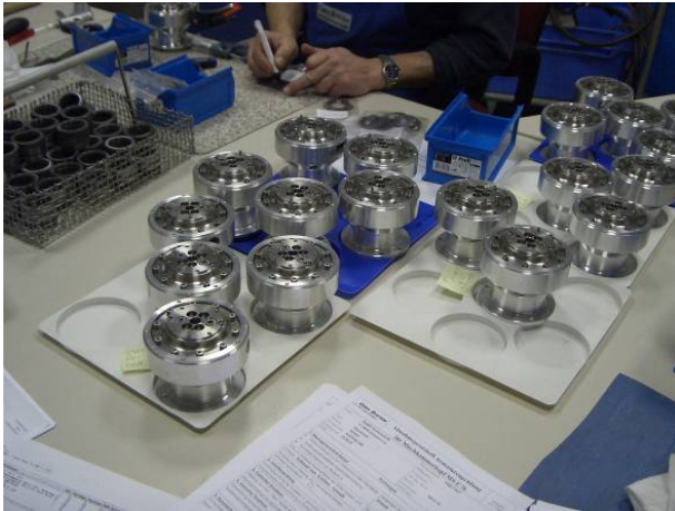
Bild 46: Drehschieber, gasdicht bis 200 bar
