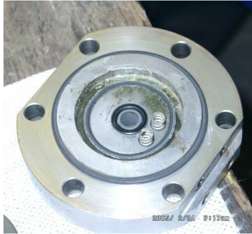
Bild 51: Korrosion ohne Sperrgas nach ½ Jahr
