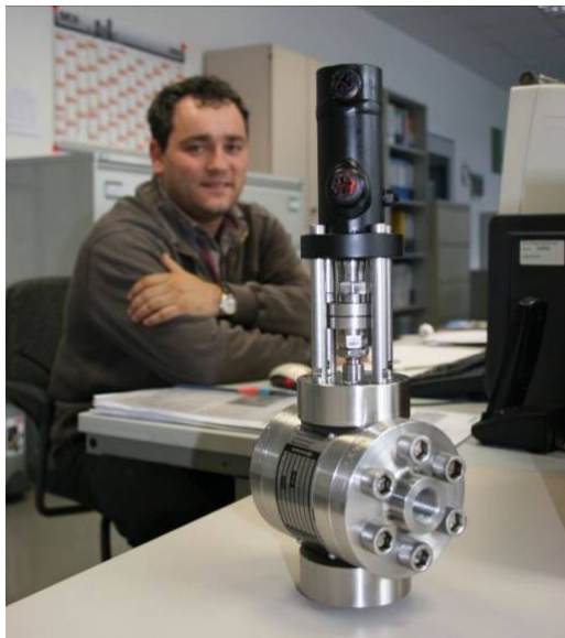
Bild 49: Hochdruckschieber, DN ½", PS 250
