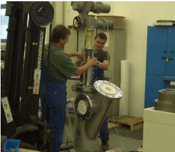
Bild 58: Rohr DN 80, Flansch DN 500, 1.250°C
