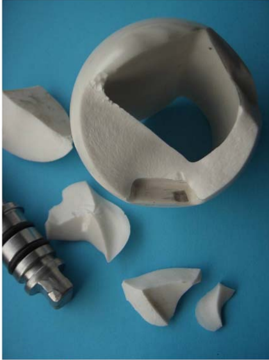
Bild 12: MgPSZ – Kugel nach Bruchtest
