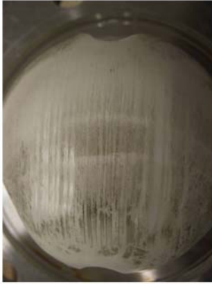
Bild 6: Kugel ZrO_2 zerkratzt
