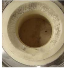
Bild 8: Al_2O_3 - Sitz ausgestrahlt durch Kavitation
