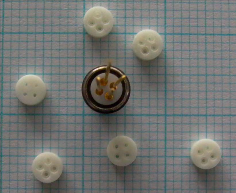
**Bild2:** Miniatursteckereinsatz aus Al<sub>2</sub>O<sub>3</sub> 99,7%, aktivgelötet
