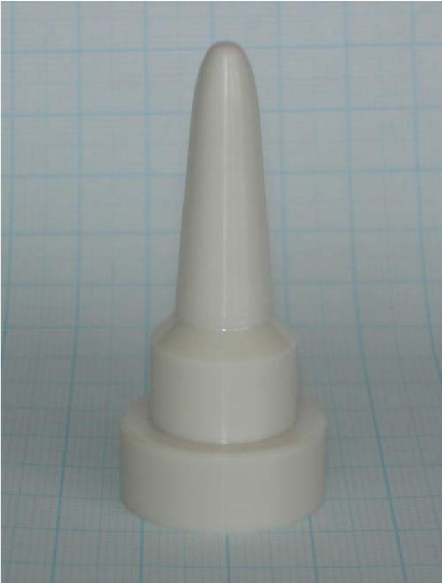
**Bild 4:** Ventilkegel aus  $ZrO_2$  Mg-PSZ
