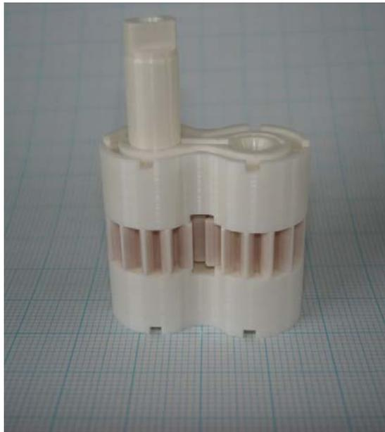
**Bild 6:** Zahnradgruppe für Pumpe aus  $ZrO_2$  Y-TZP
