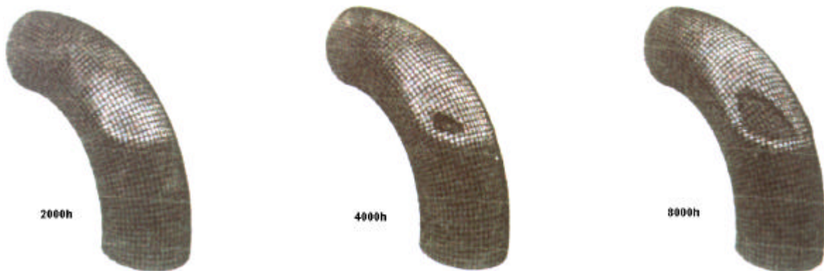
Bild 2.12: Simulation des Verschleißfortschritts als Funktion der Zeit
