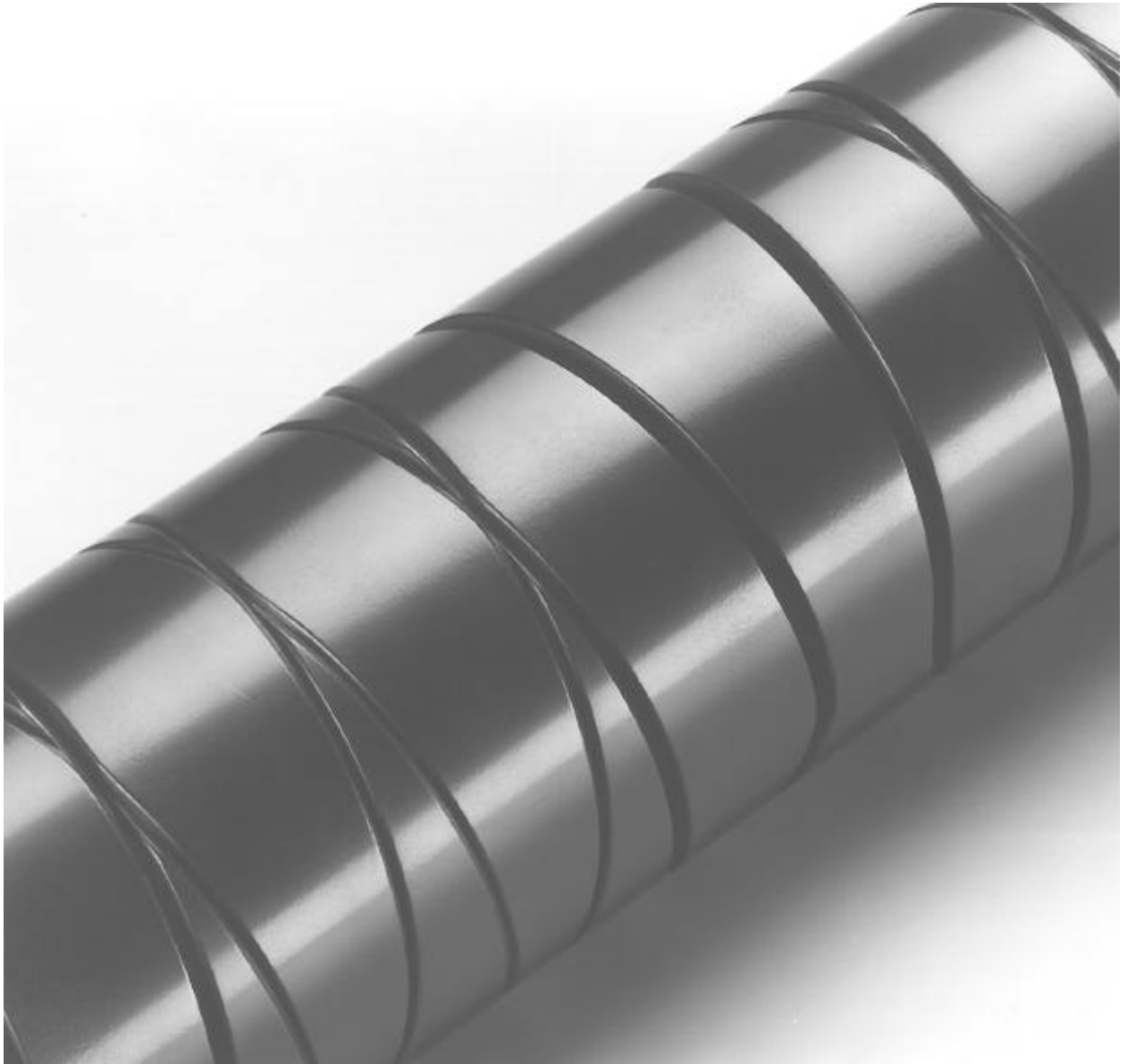
Bild 12: Kehrgewindewalze für den Textilmaschinenbau, Keramikbeschichtet mit \text{Al}_2\text{O}_3\text{-TiO}_2
